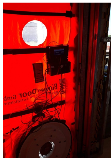
Ensayo Blower door
